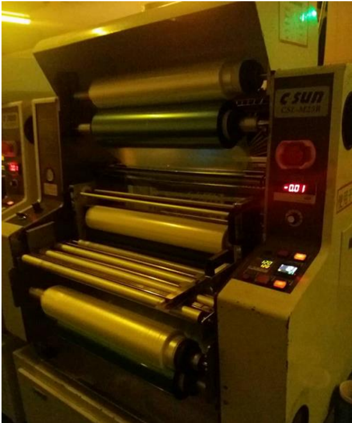
Figura 8: Macchina per la stesura della pellicola ( dry film ) fotosensibile.
