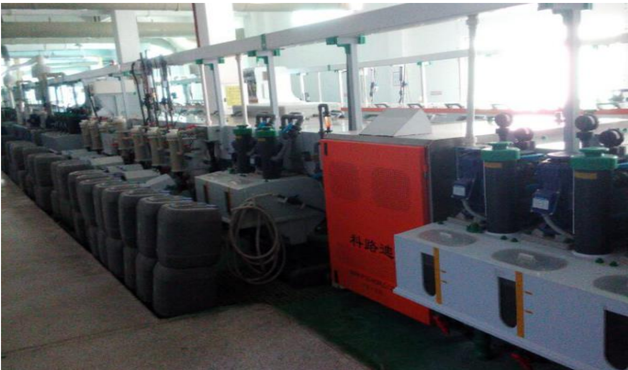
Figura 6: Macchine automatiche per la deposizione del primo strato di rame.
