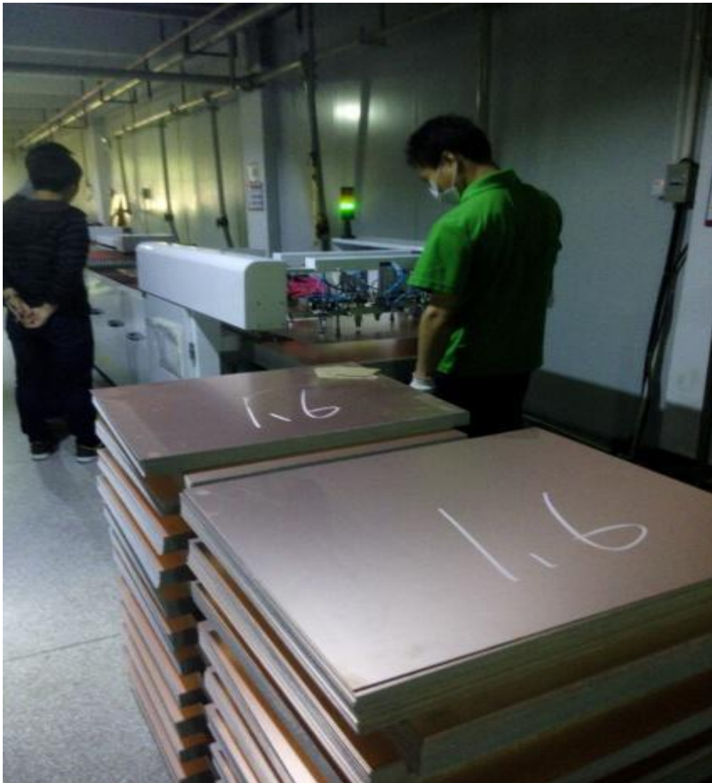
Figura 3: Cataste di pannelli di vetronite FR4 di spessore 1.6 mm pronti per essere immessi nel processo di lavorazione.
