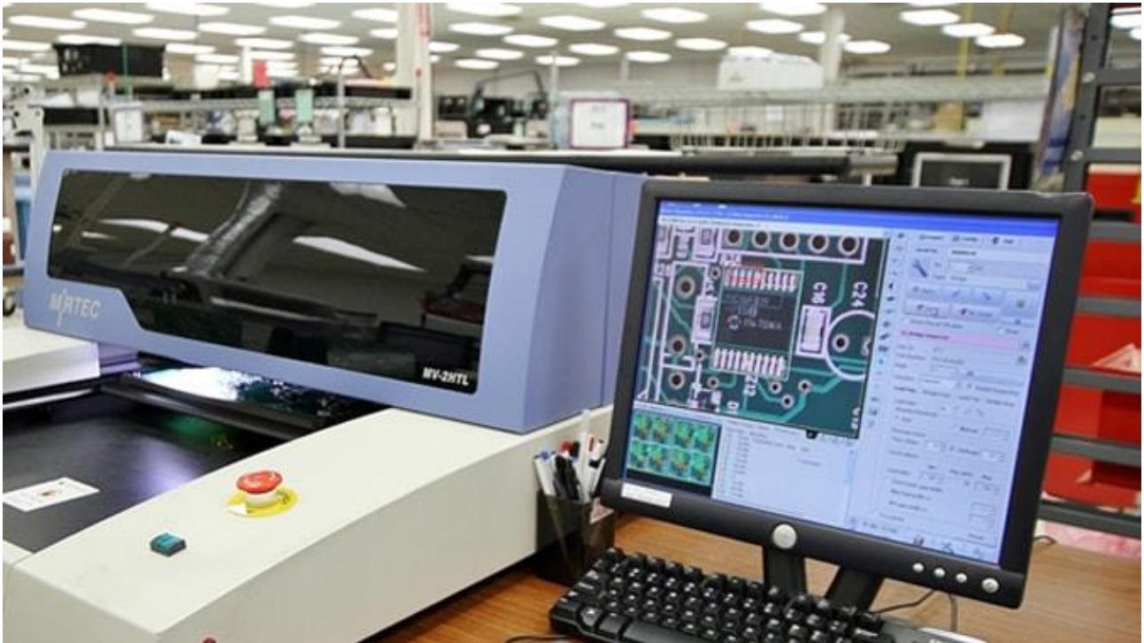
Figura 16: Macchina per l'ispezione visiva automatica (AOI)
