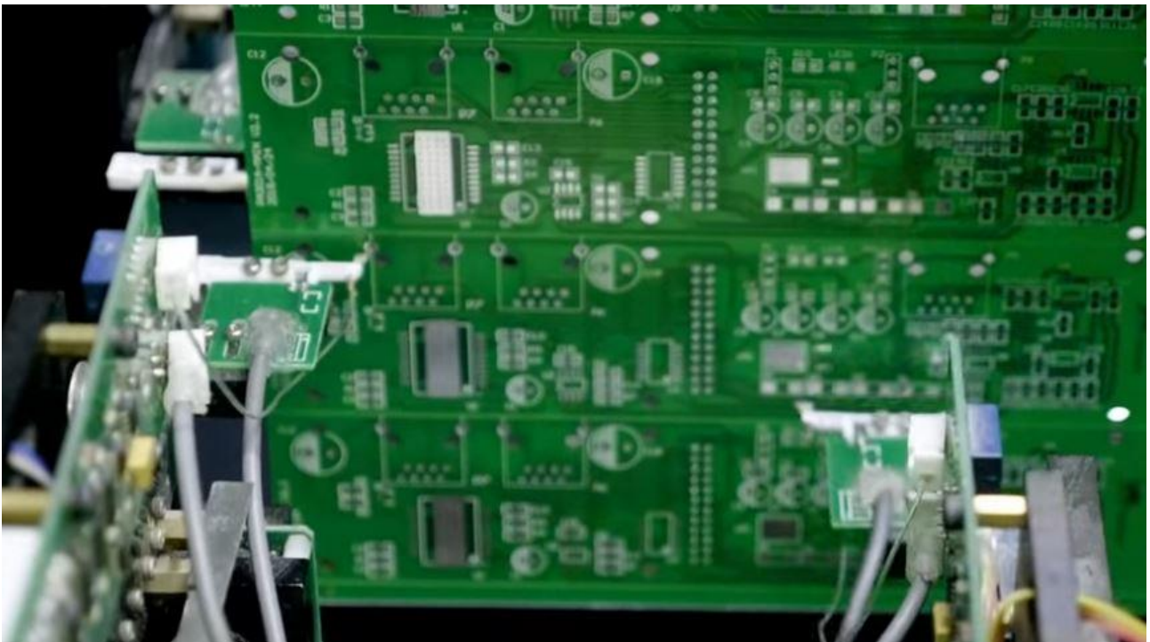
Figura 24: I due bracci della macchina automatica per il test di continuità elettrica.
