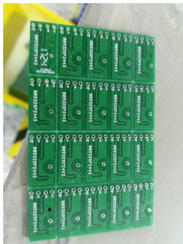
Figura 27: Pannello con più PCB dopo l'operazione di profilatura.
