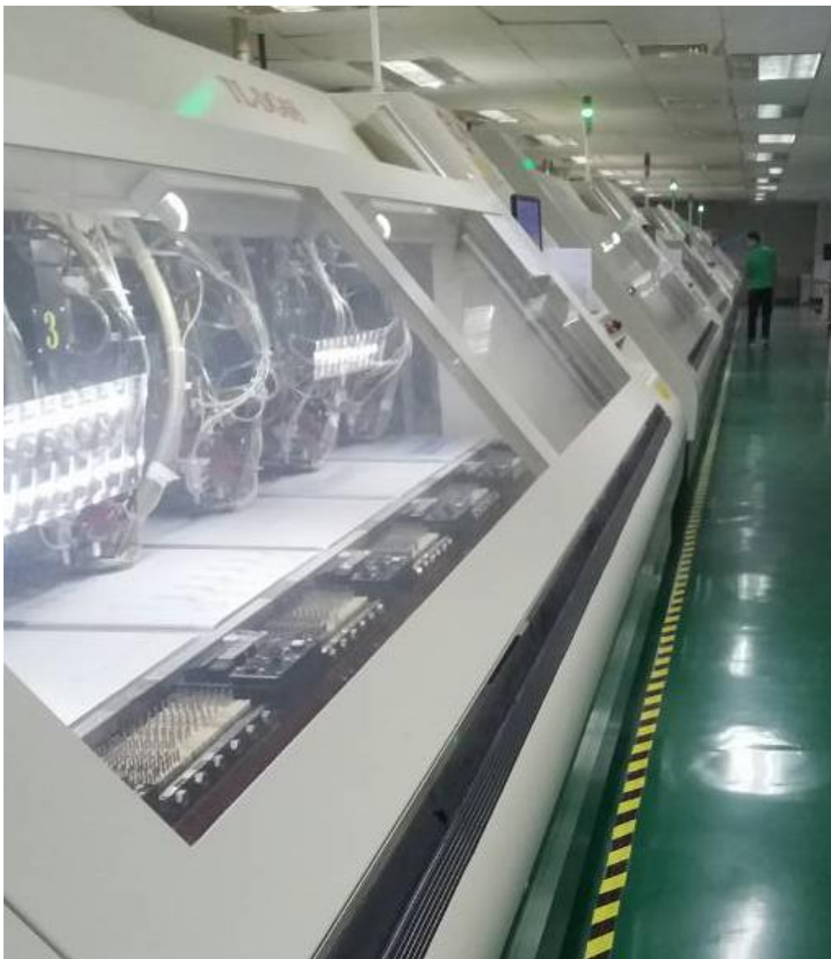
Figura 4: Macchina automatica a controllo numerico per la foratura di pannelli in vetronite FR4. Si notino in basso a sinistra le punte disponibili, di diverso tipo e diametro.
