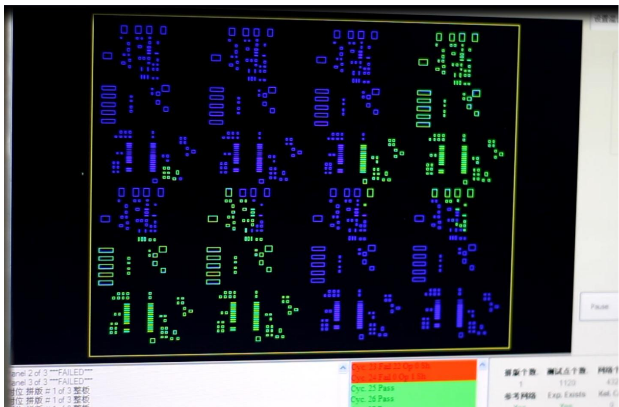
Figura 25: Monitor per la rappresentazione dell'esito del test di continuità.
